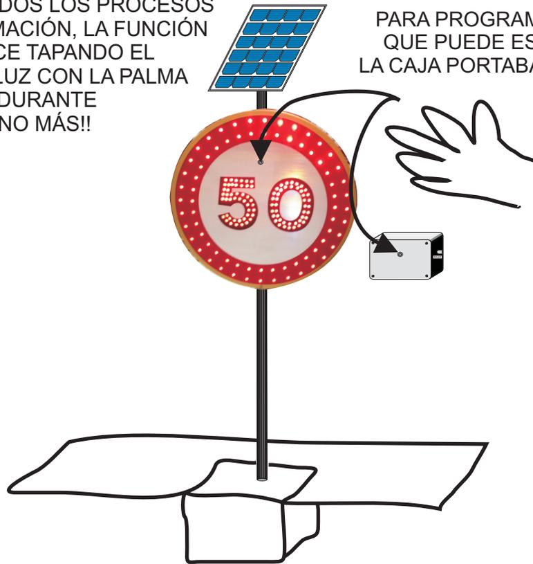
NADA MAS CONECTAR LA SEÑAL, ÉSTA COMENZARÁ A PARPADEAR DE FORMA RÁPIDA DURANTE 3 SEGUNDOS. SI DURANTE ESTOS 3 SEGUNDOS TAPAMOS EL SENSOR DE LUZ CON LA PALMA DE LA MANO ENTRAREMOS EN EL MODO PROGRAMACIÓN DE LA SEÑAL, EN EL CUAL PODREMOS CAMBIAR LA INTENSIDAD LUMÍNICA DE LA SEÑAL EN SU NIVEL MÁXIMO Y MÍNIMO, EL TIPO DE DESTELLOS, Y EN EL CASO DE QUE VAYA TEMPORIZADA POR ALGÚN DETECTOR, EL TIEMPO DE TEMPORIZACIÓN.
